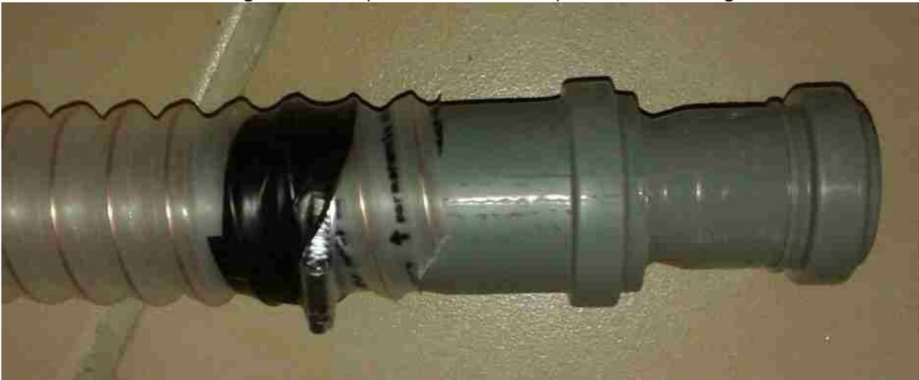
Beispiel: Schlauchanschluß der Kapp-Zugsäge (DN50/40 Übergang). Ja, die ist noch mit Putzen dran!
