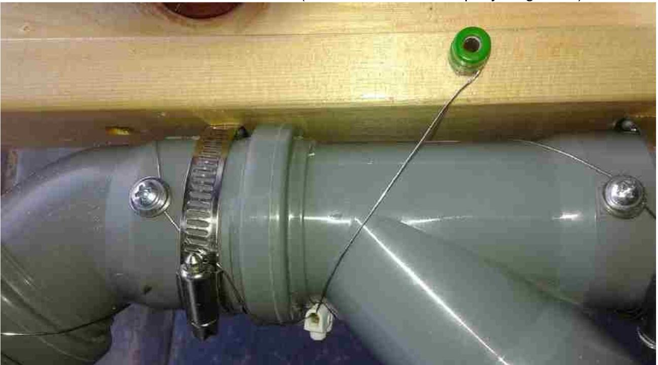
Erdverbindung zum Saugschlauch
