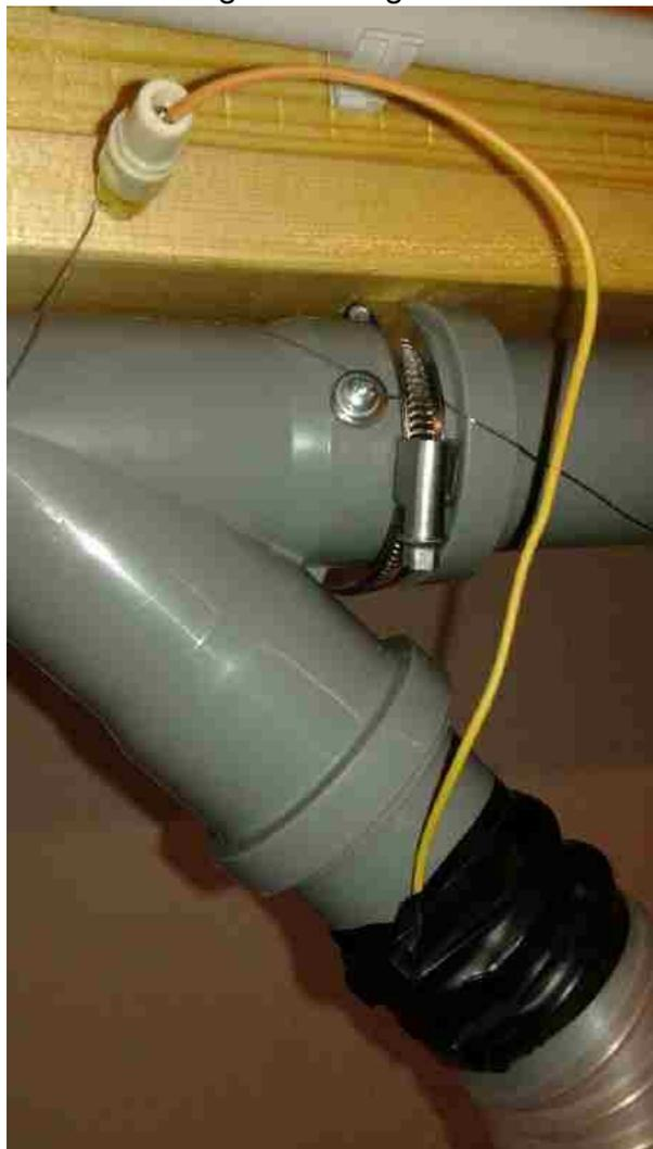
Erdverbindung Rohr zu Saugschlauch
