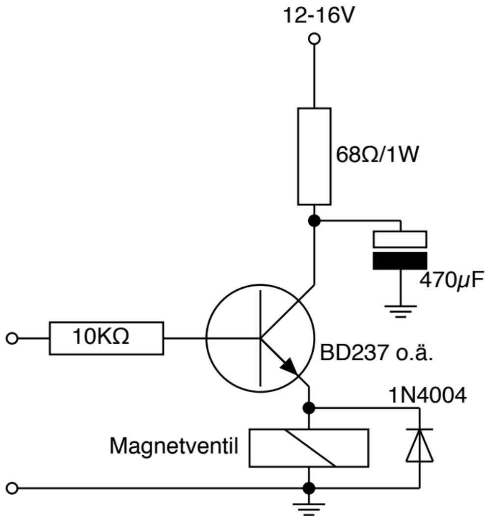
Der Elko liefert einen hohen Einschaltstrom für die Spule. Wenn er entladen ist, fließt nur noch der Haltestrom über den 68Ω-Widerstand.
